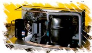
Toda la línea fue fabricada para el funcionamiento bajo condiciones límite, a temperaturas ambientales de más de 43 C° cerca de los equipos. Esto significa que la instalación del frigorífico en serie se realiza en estructuras resistentes al clima tropical.
