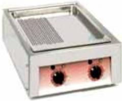
Grillfläche gerillt und Griddlefläche glatt, aus Spezialstahl mit nahtlosem Übergang zum Innengehäuse. Eingelassene Auffangschale in der vorderen Griddlefläche für den Fettablauf. Temperatur links und rechts thermostatisch regelbar bis 250°C.
