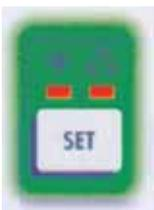
Mit dieser Taste kann man die Konservierung nach der Schnellabkühlung - Schockfrostphase ausschließen.
