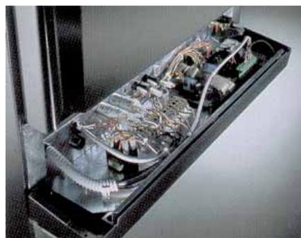
Sämtliche Komponenten der Kühl- und der elektrischen Anlage können leicht erreicht werden.
